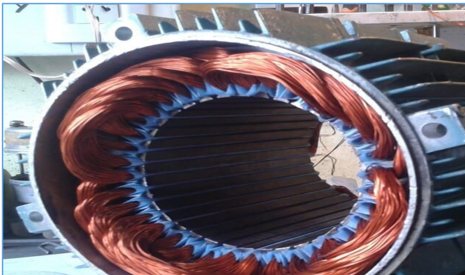
Figure I. 2 : Construction d'un stator
