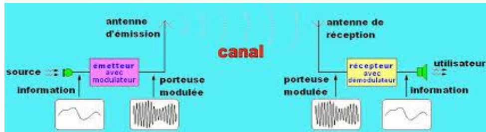
Figure I-4 Un système de communication radio par (OEM) [15]
