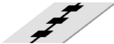
Figure II-7 alimentation série d'un réseau d'antennes [1]
