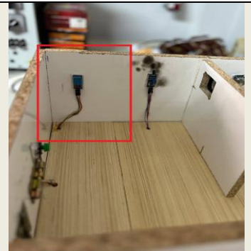
Figure 89 Placement du capteur DHT11 sur le mur
