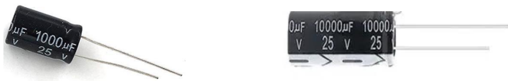
Figure II.22 Condensateur électrolytique 1000 \mu\text{F} – 25 V utilisé pour la stabilisation de l'alimentation
