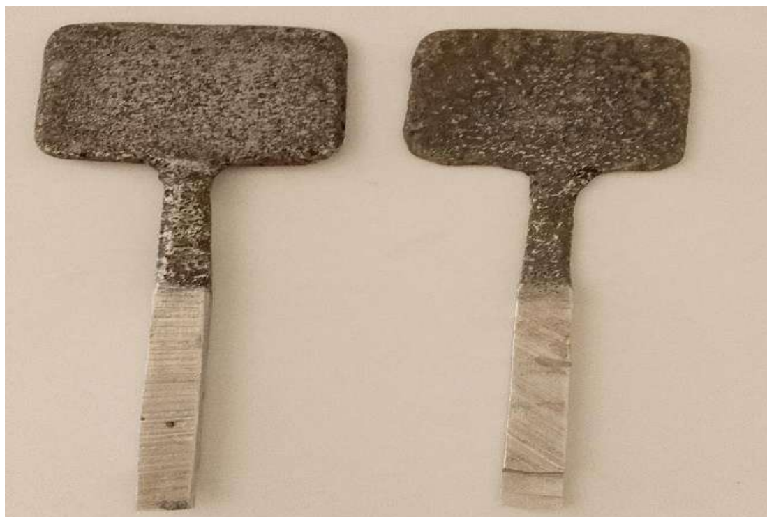
Figure III.1: Electrodes utilisés pour l'électrocoagulation.
