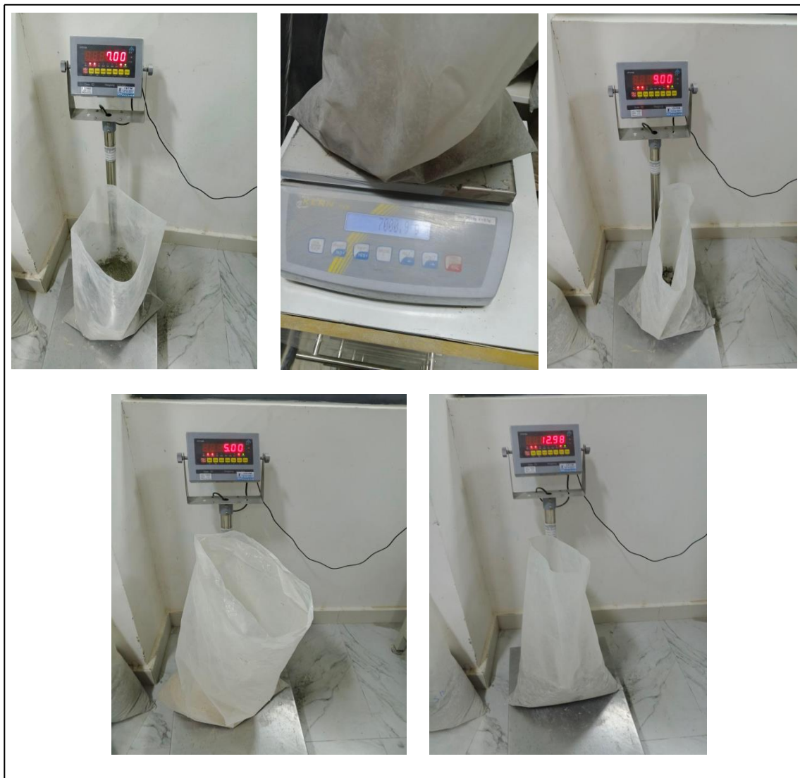
FigureII.17: Pesée des matériaux pour la préparation du béton.
