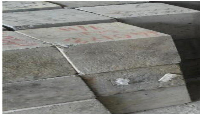
Figure II.21: Échantillons de béton identifiés prêts pour l'essai de compression.[21]
