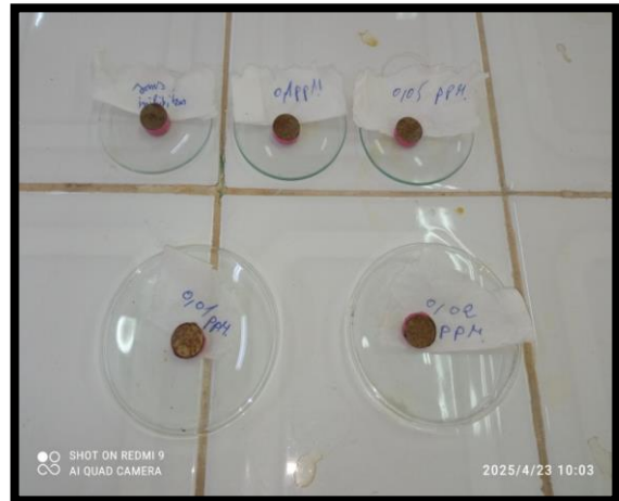
Figure II.20 : L'apparence de l'échantillon après 6 heures d'immersion.
