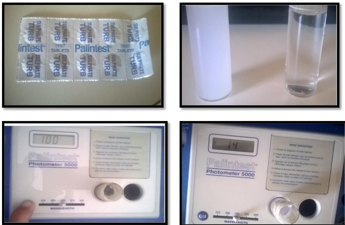
Figure II.10 : La méthode de dosage des sulfates.
