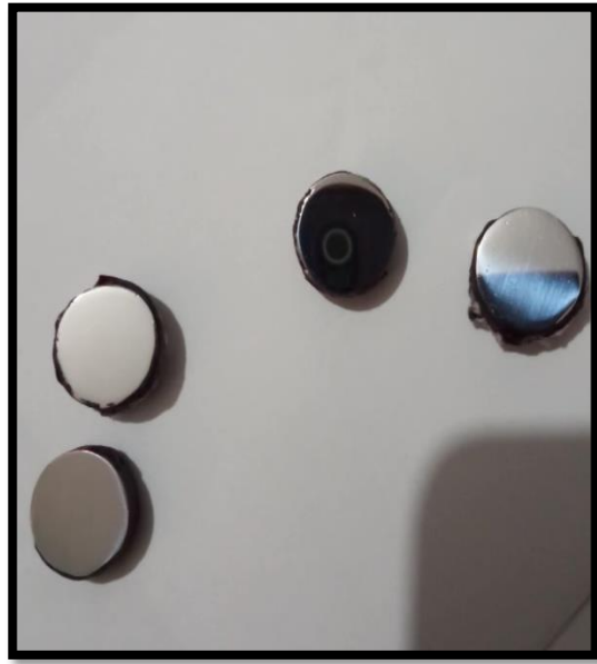
Figure II.12 : L'apparence de l'échantillon X70 après polissage.
