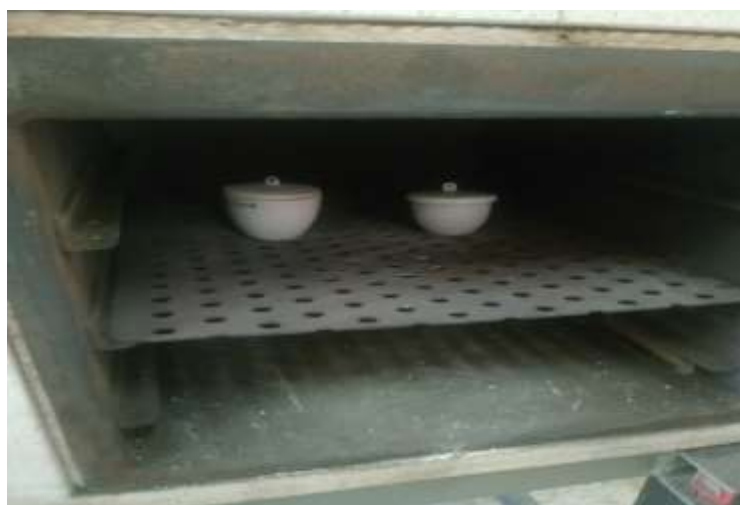
Figure III .7: Calcination de la poudre d'épluchures de banane.
