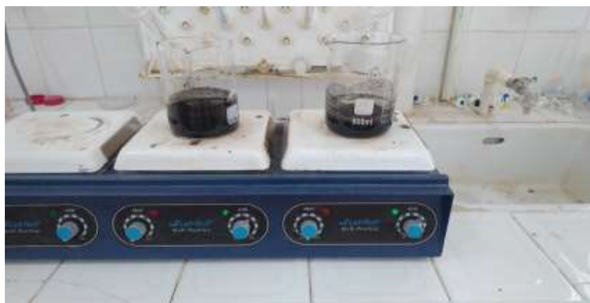
Figure III .8: L'activation de la poudre d'épluchures de banane.
