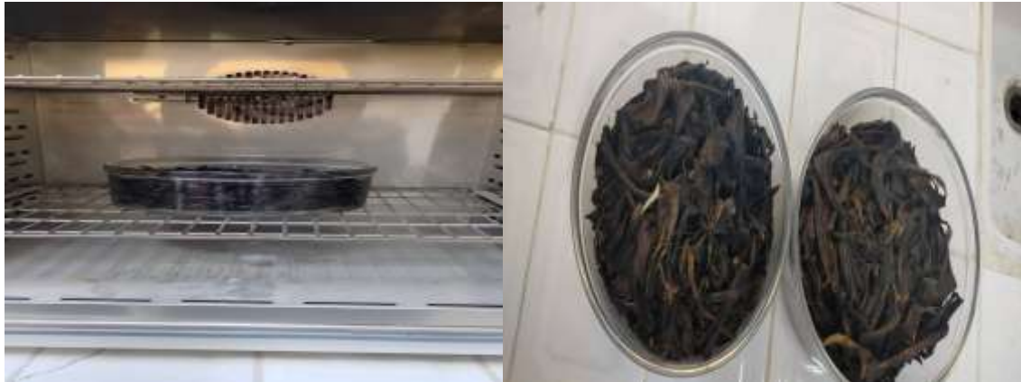
Figure III .4: épluchures de banane séchées à l'étuve.
