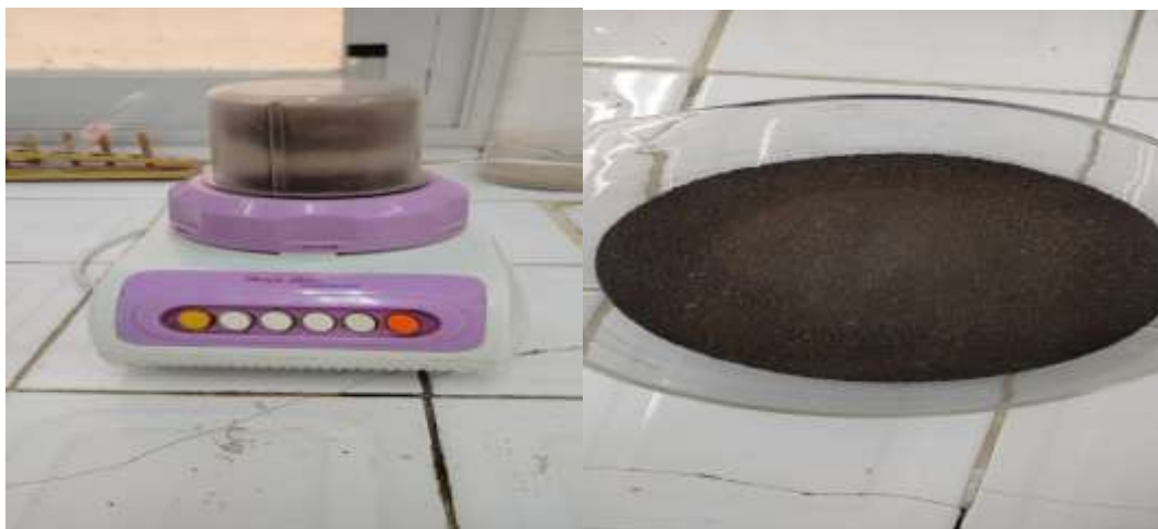
Figure III .5: Broyage des épluchures de banane
