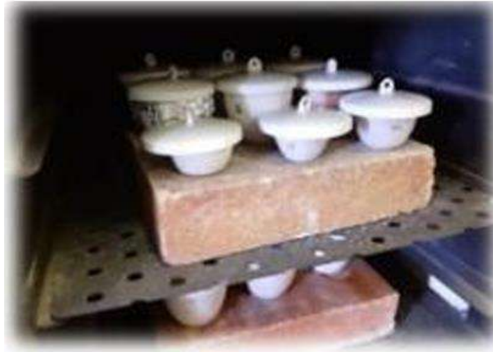
Figure 3-6: La carbonisation dans un four à moufle T=400^{\circ}\text{C} pendant 2h
