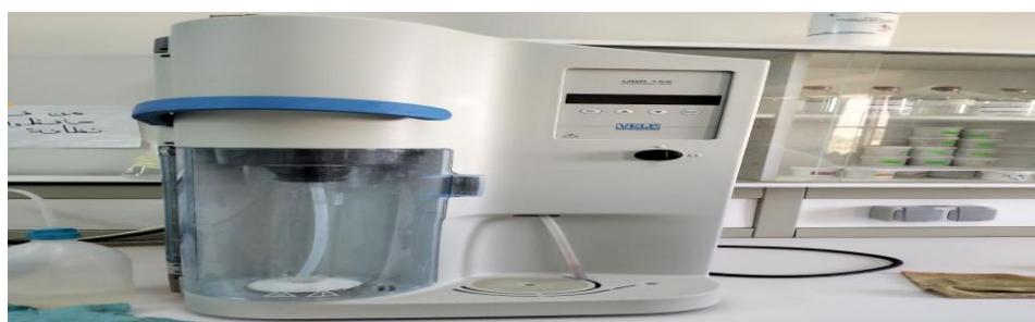
Figure 2.5. Appareil de distillation de type unit – UDK 129.
