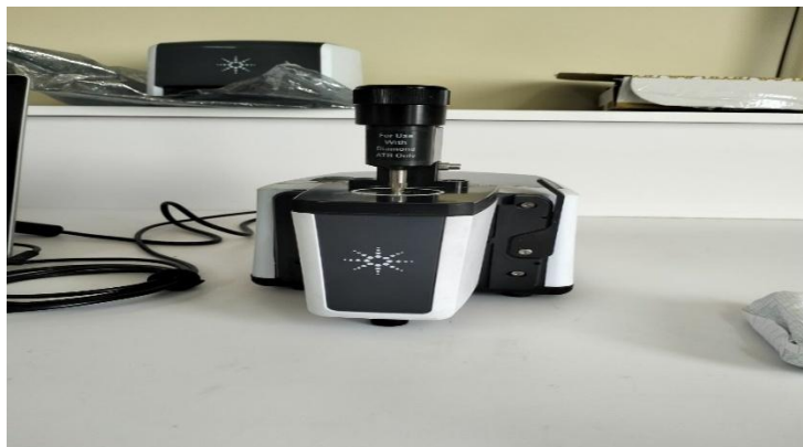
Figure 2.7. Spectroscopie FTIR de la marque Agilent Cary 630 est équipé d'un appareil FTIR/ATR-DRIFT.
