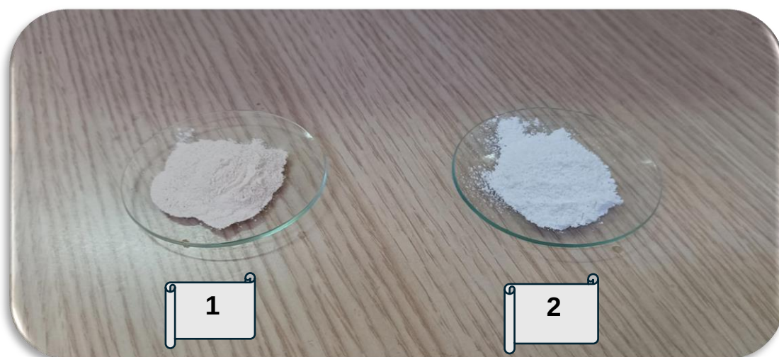
Figure III.6 : La cellulose obtenue à partir deux sources : Cellulose 1 (la paille) / Cellulose 2 (déchet de coton (TR) ).
