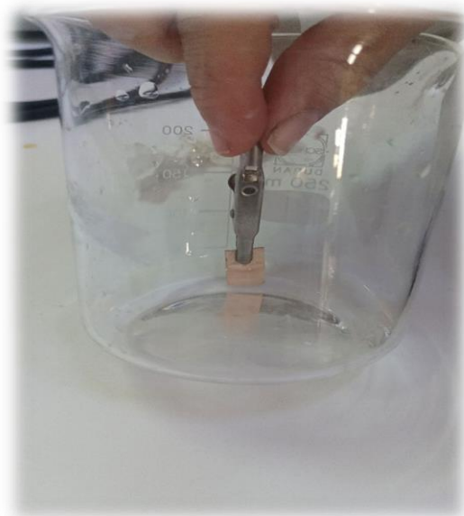
Figure III.11 : Schéma de décapage chimique.
