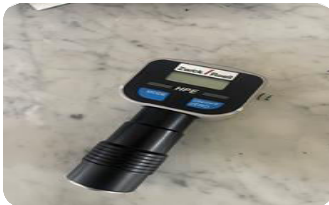
Figure 3.18. Appareil de mesure de dureté de type HPE – Zwick/Roell.
