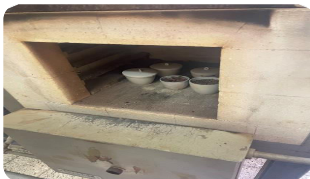
Figure 3.8. Procédé de carbonisation dans un four de laboratoire
