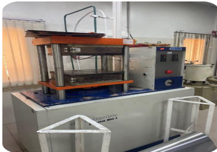
Figure 3.14. Presse hydraulique de type Schwaben han poly stat 300 S.
