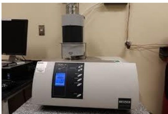
Fig III.6 : Calorimètre Différentielle à Balayage (DSC) (CRAPC)
