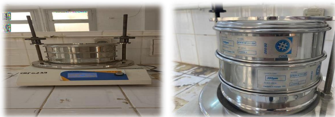
Fig III.5 : Tamisage de l'adsorbant
