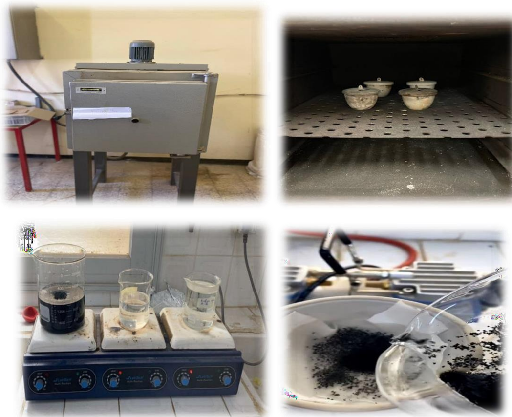
Fig III.4 : la carbonisation et le lavage de l'adsorbant
