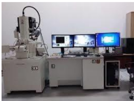
Fig III.12 : Un microscope électronique à balayage (CRAPC)
