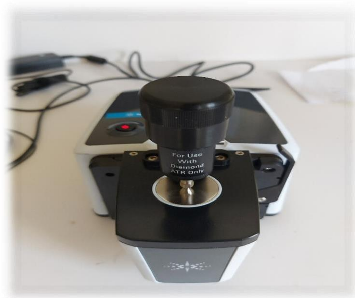
Fig III. 10 : Spectromètre Infrarouge à Transformée de Fourier (FTIR/ATR-DRIFT)
