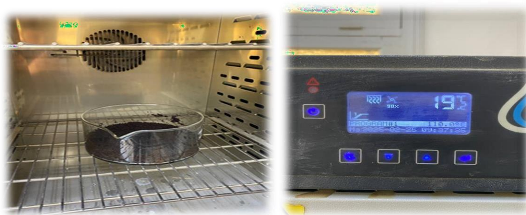
Fig III.3 : Séchage de l'échantillon dans une étuve
