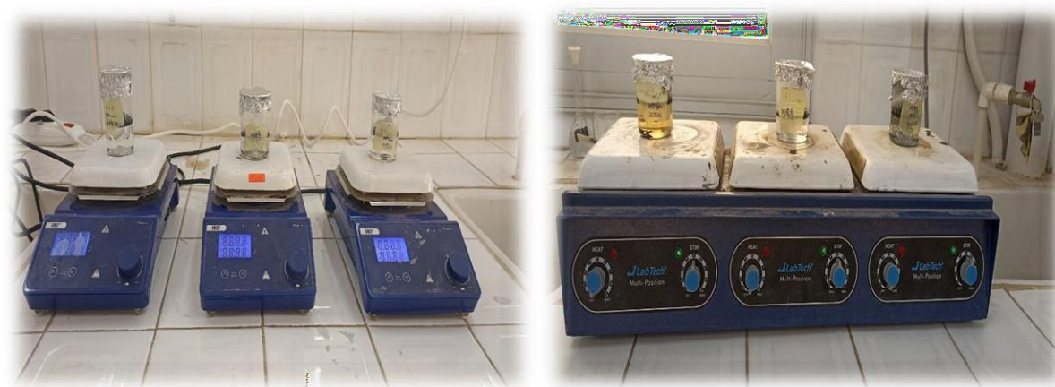
Fig III.8 : Essais de détermination de pH point de zéro charge
