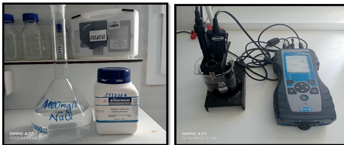
Figure IV.12 : Préparation de solution de NaCl.
