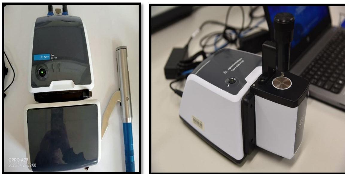
FigureIV.10 : Technique de FTIR dans les adsorbants utilisés est réalisée à l'aide d'un appareil Spécifique (Agilent cary 630 FTIR - Laboratoire de recherche CRAPC-Biskra).
