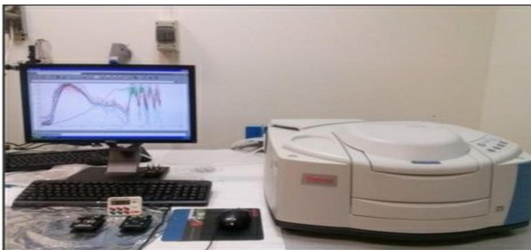
Figure II.5: Spectroscopie infrarouge par transformée de Fourier (IRTF). [14]
