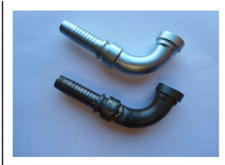
Fig I.5 : Revêtement métallique de zinc sur les pièces métalliques
