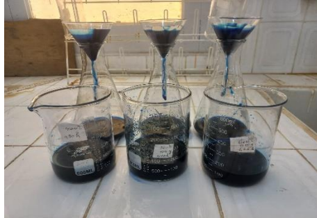
Figure III.16 : procédé de filtration
