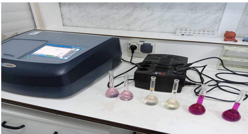
Figure III.3: Dosage de nitrite par spectrophotomètre UV-Visible
