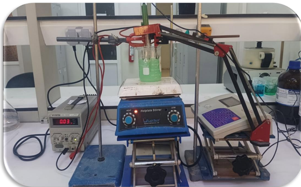
Figure III.12 : Dispositif expérimental de l'électrodéposition Ni-P-acétate de cellulose
