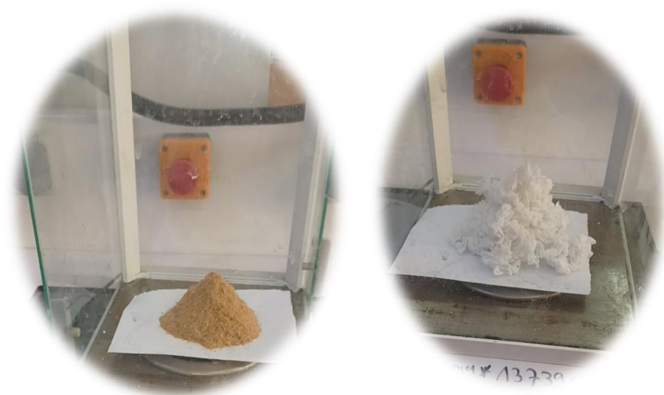
Figure III.2 : Prétraitements des fibres naturelles
