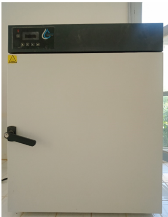
FIGURE III.4 – Étuve utilisée pour incuber les échantillons à température constante.
