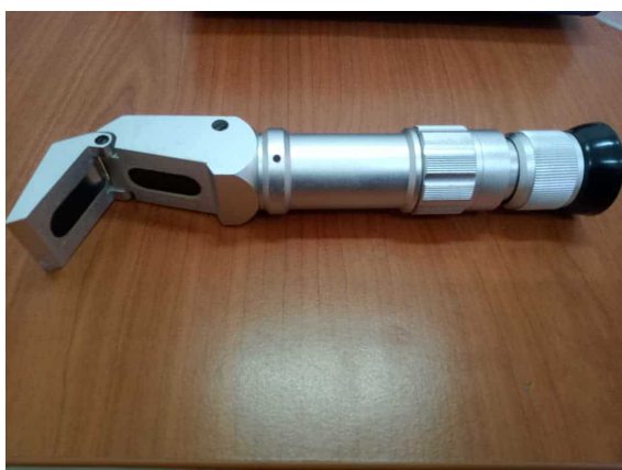
FIGURE III.3 – Réfractomètre utilisé pour la mesure de la concentration en sucres dans les jus de dattes.
