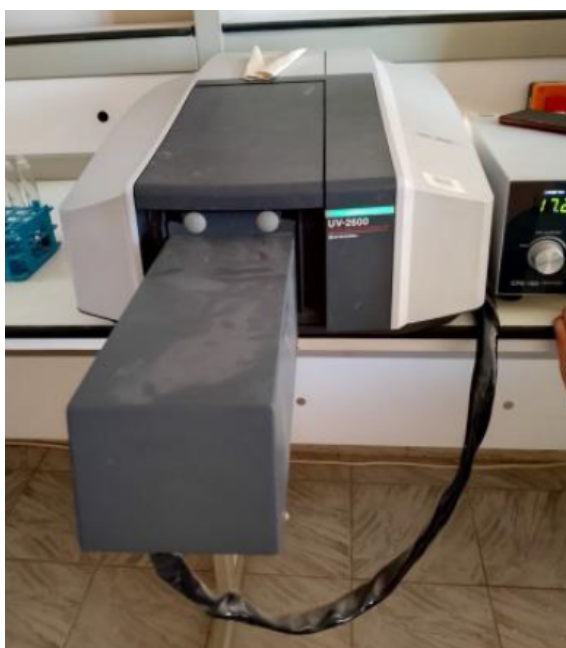
FIGURE III.5 – Spectrophotomètre UV-Vis utilisé pour analyser le spectre du bioéthanol.
