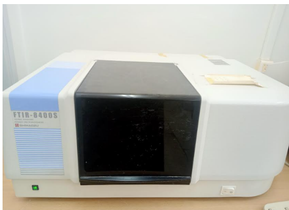
FIGURE III.7 – Spectrophotomètre FTIR utilisé pour analyser la structure moléculaire du produit final.
