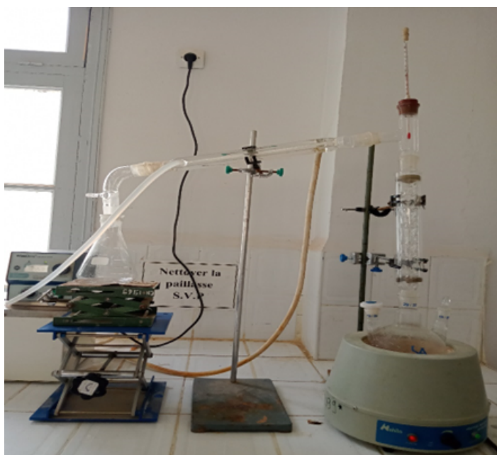
FIGURE III.12 – Montage de distillation fractionnée pour la récupération de l'éthanol
