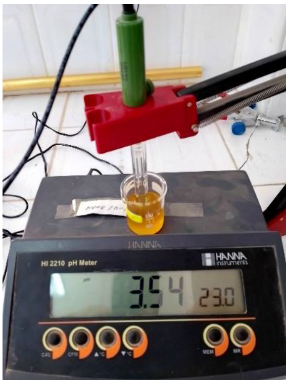
FIGURE III.6 – pH-mètre utilisé pour contrôler l'acidité du milieu de fermentation.
