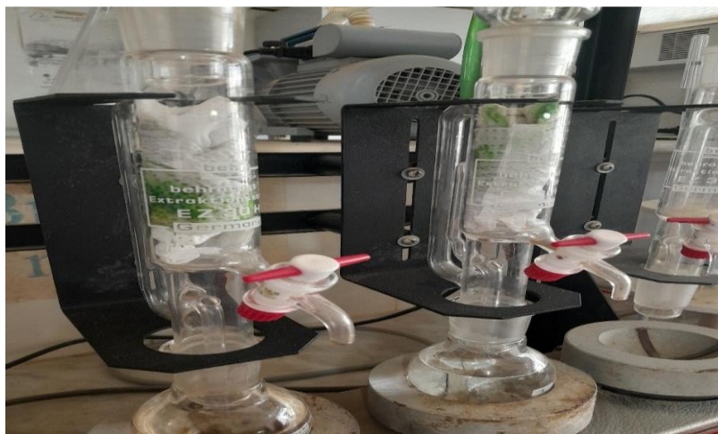
Figure III.5 : Les ballons d'ébullition ainsi que les cartouches contenant les échantillons ont été placés dans l'appareil.
