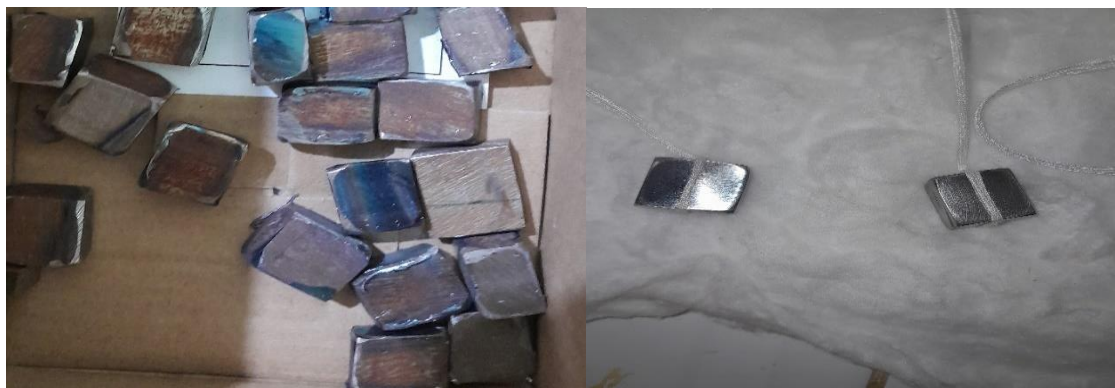
Figure III.12 : pièces d'acier XC42 avant et après polissage.
