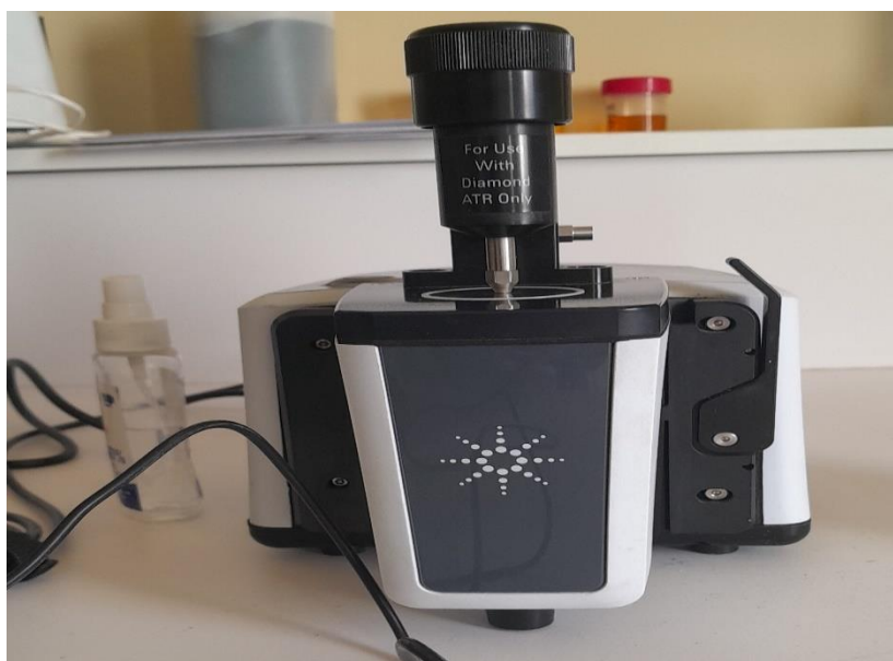
Figure III.8 : spectroscopie infrarouge à transformée de Fourier (FTIR) Agilent Cary 630.
