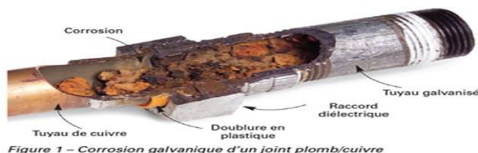
Figure 1 – Corrosion galvanique d'un joint plomb/cuivre
