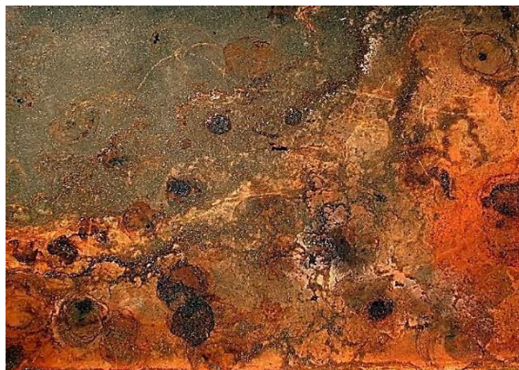
Figure (I.3): La Corrosion Par Piqure.
