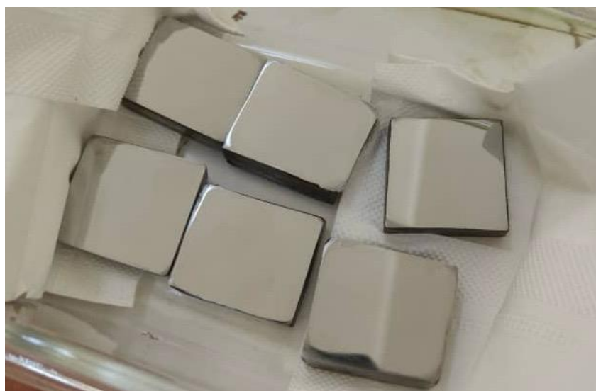
Figure (II.9) : l'échantillons de l'acier API 5L X70 d( 3 \times 3 \times 1 cm) après polissage mécanique
