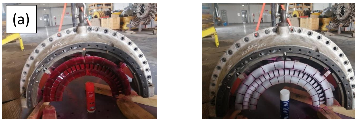
Figure III. 7 : (a) stator avec pénétrant, (b) stator avec révélateur
