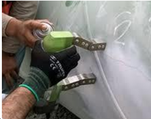
Figure II. 10 : Contrôle par magnétoscopie
