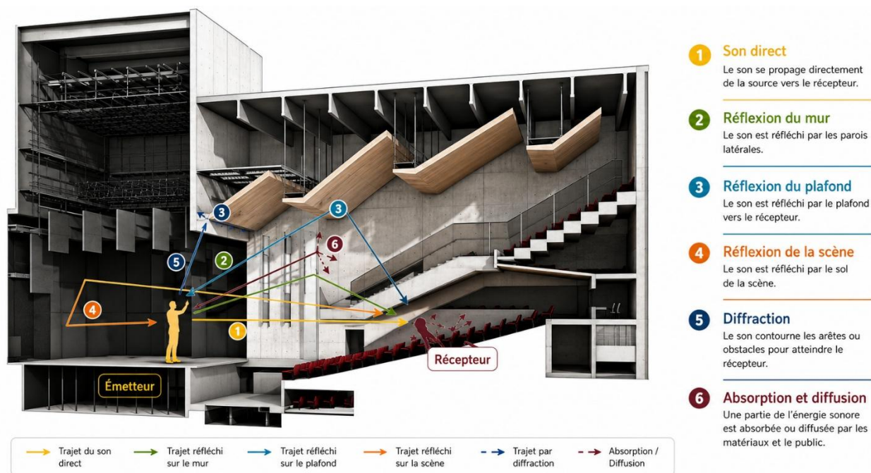
Figure 15. Le comportement physique d'une onde acoustique dans un auditorium ( http://www.uncubemagazine.com )
