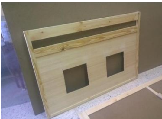
Figure 29. Modélisation des parois échelle \frac{1}{4} (source : Daich, 2019)
