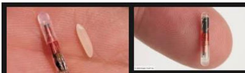
Figure IV.6 : Puce miniature implantable sous la peau (comparée à un grain de riz) destinée à la surveillance biométrique et médicale.
