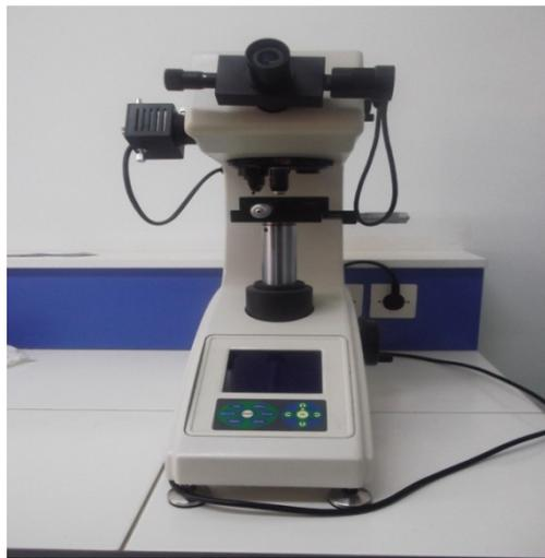
**Figure II.5 :** Un microduromètre.
