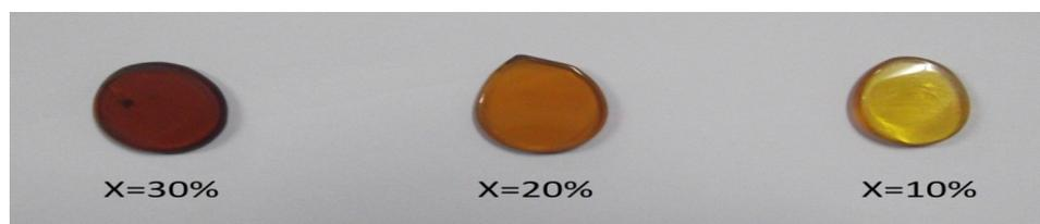
**Figure III.3 :** Photographie des verres dopés du système  $(90 - x)Sb_2O_3 - 10K_2O - xMoO_3$ .
