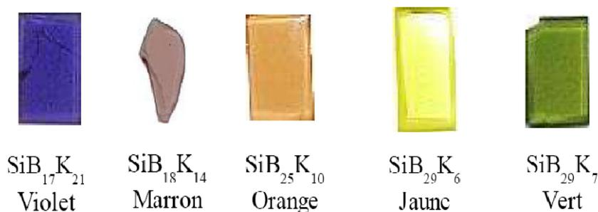
**Figure I.6 :** Couleur des verres borosilicates dopés au nickel.
