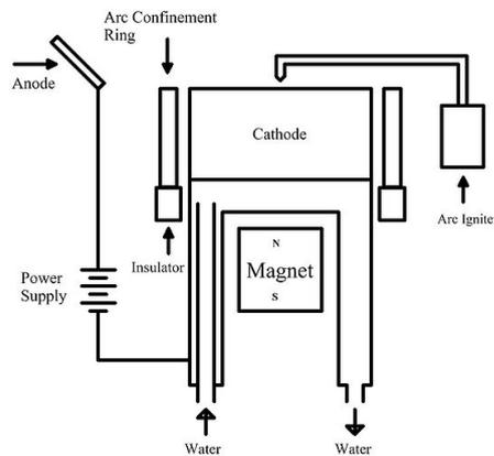
Figure II.7) Cathodic Arc Source (Sablev type) [38]
