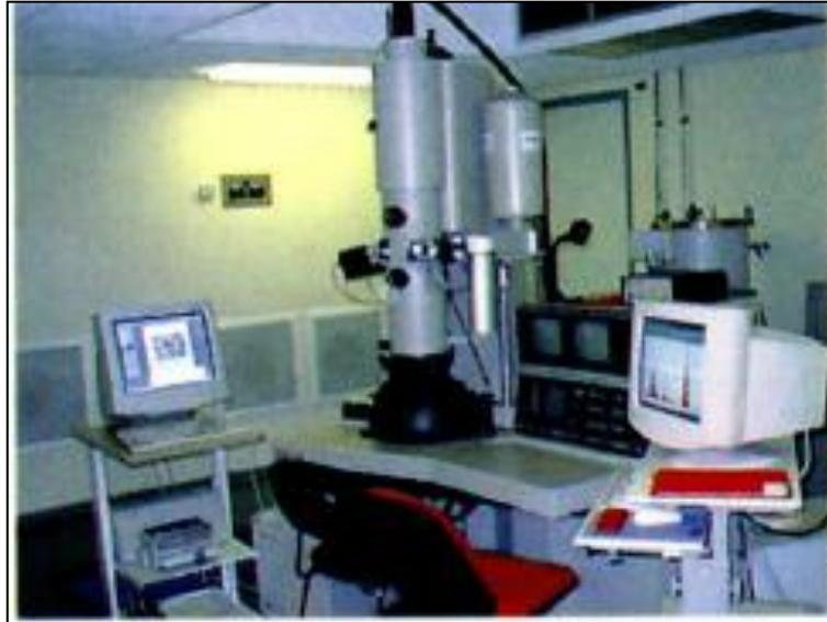
**Figure III.12:** *Microscope Electronique à Transmission (MET).*
