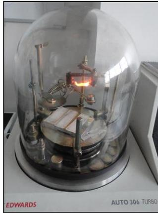
**Figure I.16:** *Bâti de dépôt par évaporation thermique.* [PRISME ; site de Chartres]
