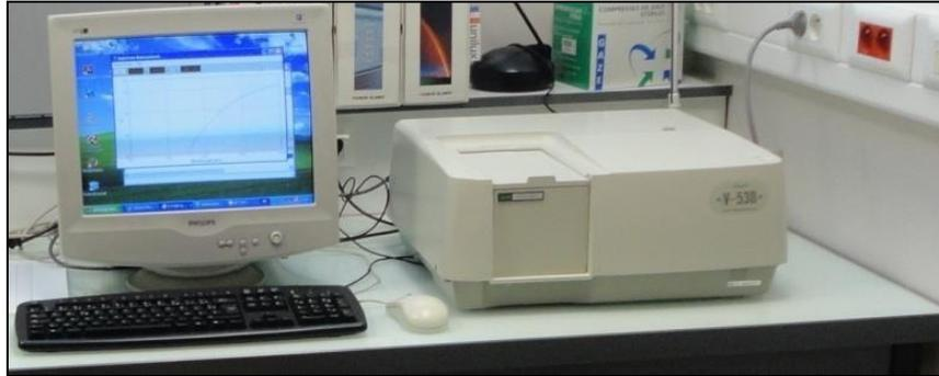
**Figure III.22:** *Le spectrophotomètre, UV JASKO V-530 version 1.53.
