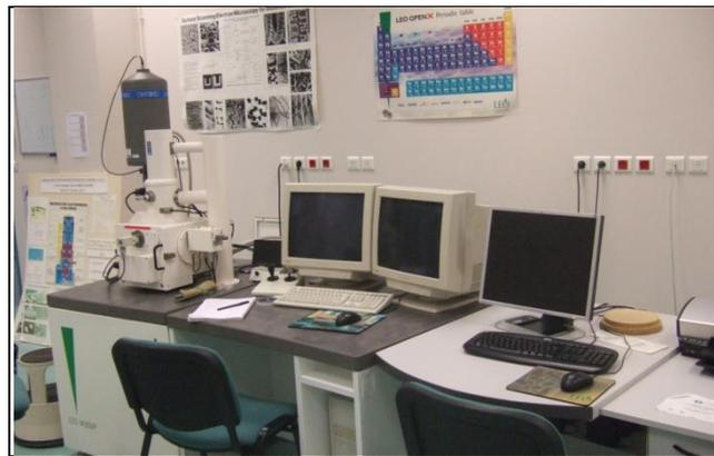
**Figure III.11:** *Microscope Electronique à Balayage. [PRISME, site de Chartres]*
