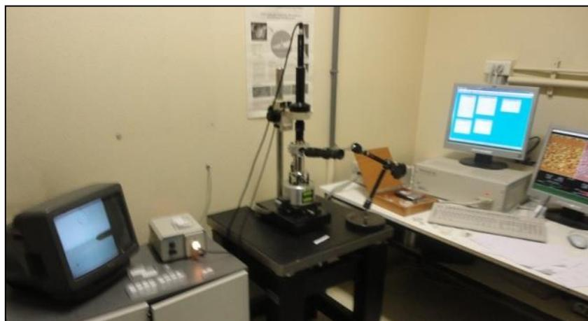
Figure III.16: Microscopie à Force Atomique.
