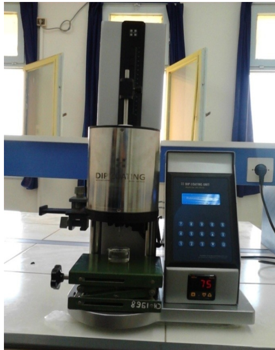
Figure II.7 Photographie du montage expérimental du dip coating
