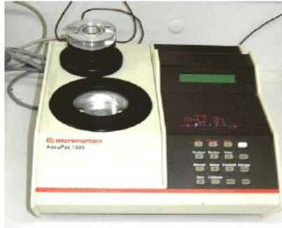
**Figure II-17 : Pycnomètre à hélium modèle ACCUPYC 1330 MICROMERITICS**
