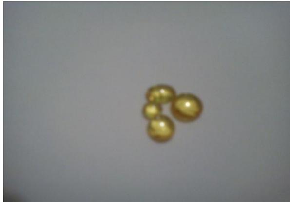
*Figure II-4 : Échantillon verre sous forme de gouttelettes.*
