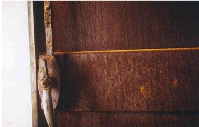
Fig I.1 : Corrosion uniforme
