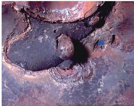
Fig I.3 : Corrosion galvanique
