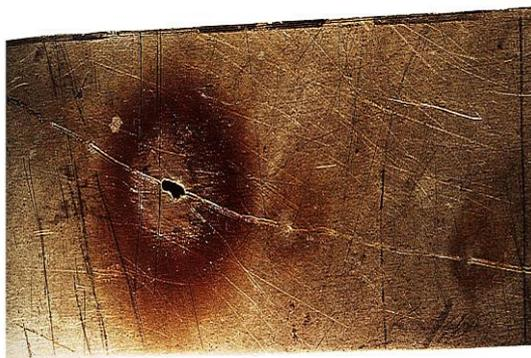
Fig I.2: Corrosion par piqure
