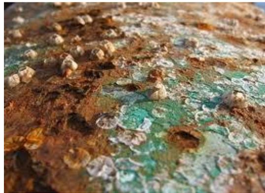
Fig I.5 : Corrosion caverneuse
