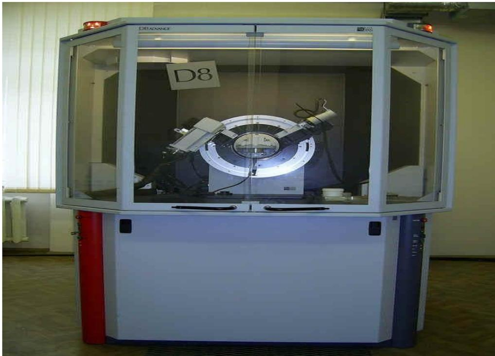
Fig III.4: Système de diffraction par rayon X.
