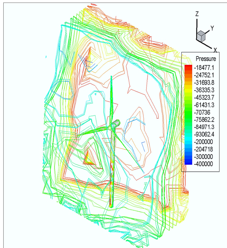
Figure 4.4a : Représentation du champ de pression autour d'une éolienne (forme I)
