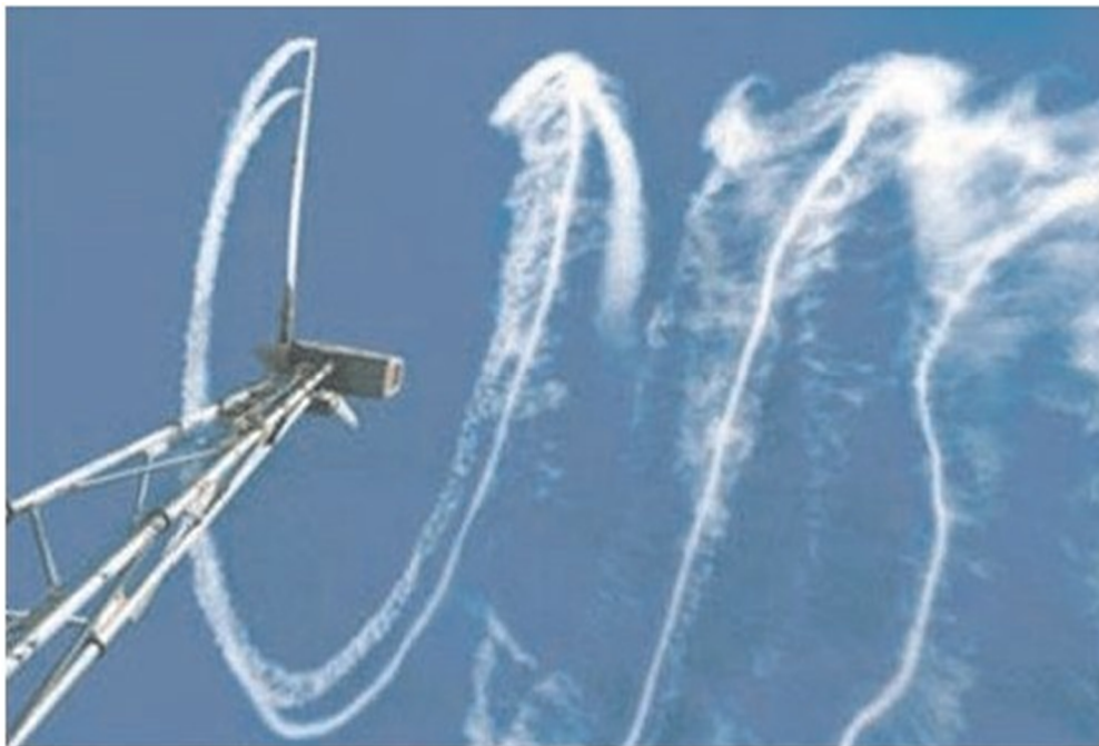
Figure: 2.2 : Expérience réalisée par le centre DANOIS de recherche sur l'énergie « riso Ø », montrant le sillage d'une éolienne à une seule pale [19]
