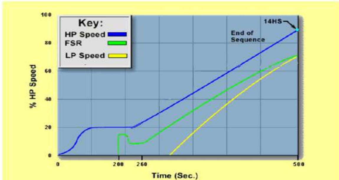
Entre la phase d'accélération et la phase de fin de séquence, la machine risque d'aller en survitesse et pour éviter cela on applique une consigne importante d'ouverture de la vanne de gaz (GCV) pour donner la main au régulateur du débit du fuel gaz et les nozzles afin de maintenir la vitesse de fonctionnement constante.
