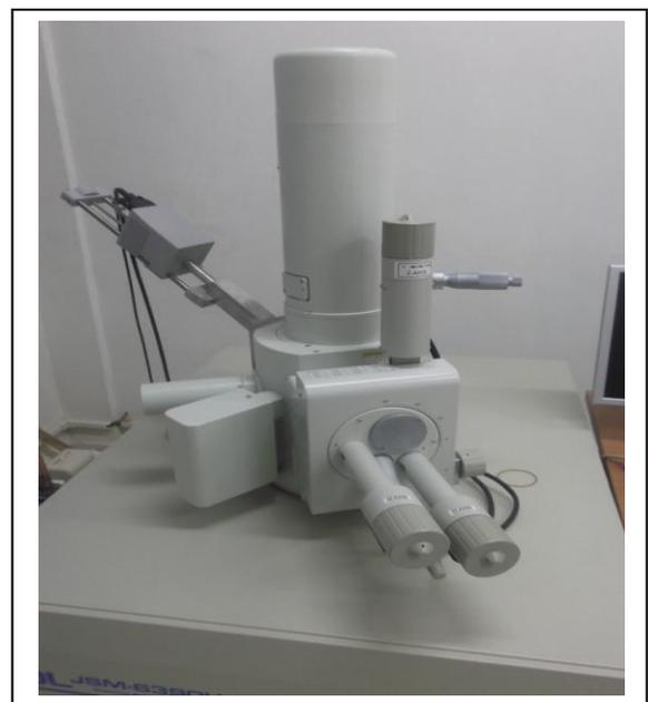
**Figure 3.7:** Microscope électronique à balayage de type JEOL
