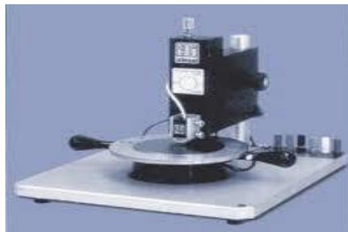
**Figure II.27** : Dispositif quatre pointes, modèle C4S-4 –Point Probe Head.
