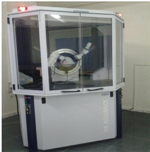
**Figure II.15** : Diffractomètre D8 ADVANCE.
