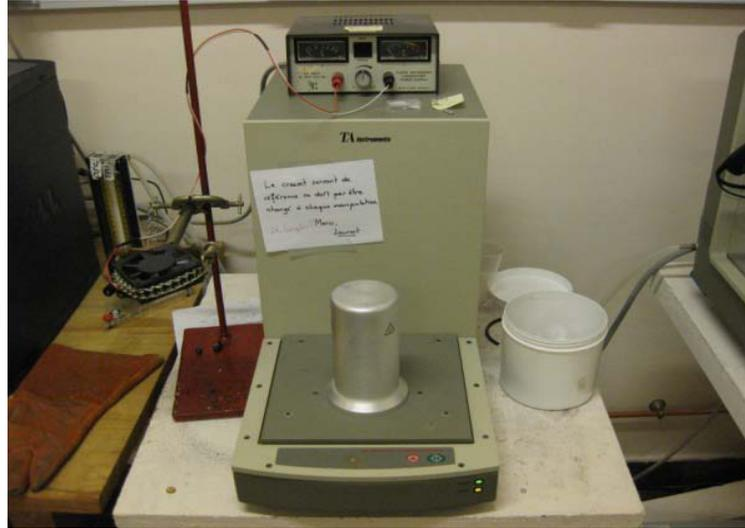
*Figure II-8: L'appareil de DSC*
