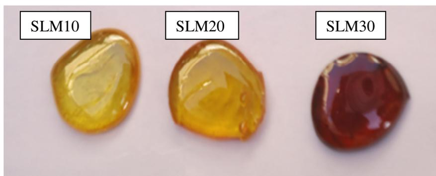
**Figure III-2:** Photographie des verres avant la recristallisation du système  $(80-x)\text{Sb}_2\text{O}_3-20\text{Li}_2\text{O}-x\text{MoO}_3$ .
