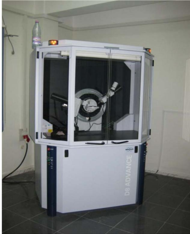
**Figure II-5:** *Diffractomètre à rayons X de type Bruker D8 ADVANCE.*
