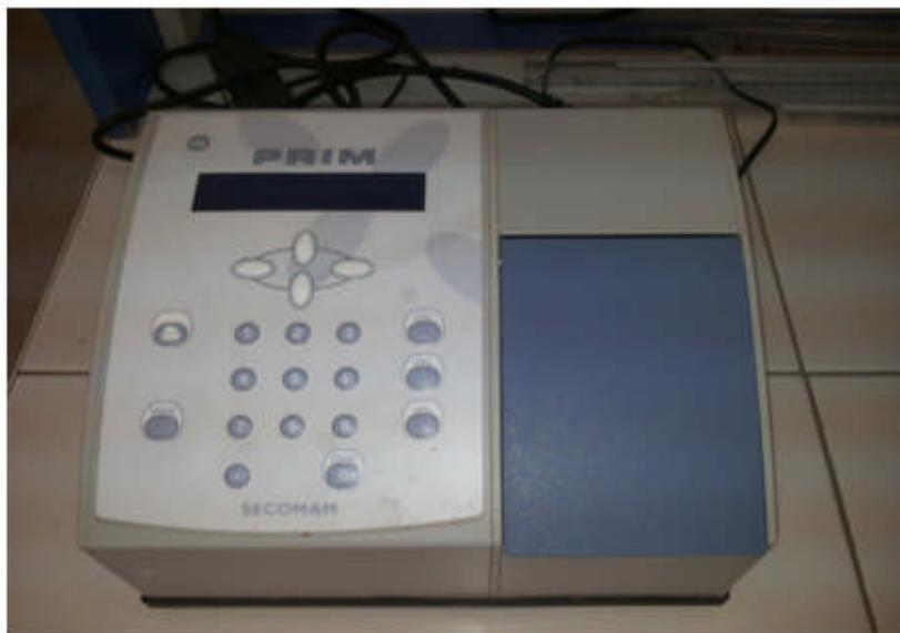
**Figure II 3** : spectrophotomètre PRIM SECOMAM RS 232.
