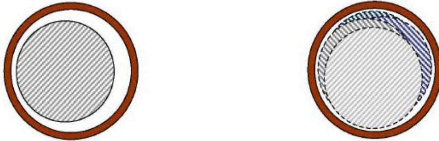
**Figure I.5 :** *Modélisation schématique de l'excentricité statique et dynamique.*
