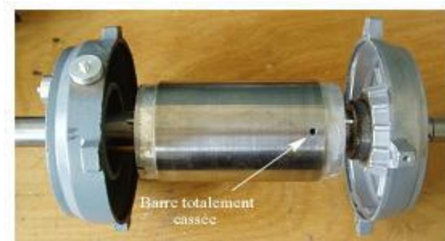
**Figure I.7 :** Photo d'une barre cassée [9].
