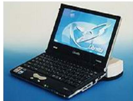
**Fig (1-5): Pile à combustible au méthanol Toshiba (2004), autonomie = 20h, poids = 900g.**
