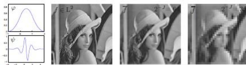
**Figure. 1.7 :** Discrétisation d'une fonction 2D. Chaque pixel correspond à un coefficient  $f[n]$  de la projection de  $f$  sur une fonction d'échelle
