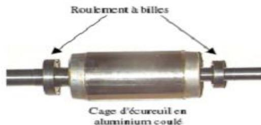
(Fig. I.5) : Photo du rotor d'une machine asynchrone
