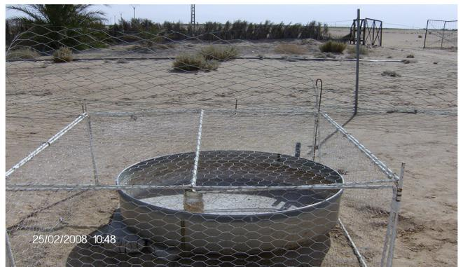
Figure 3: BAC CLASSE « A » (pour la mesure de l'évaporation de l'eau de surface)
