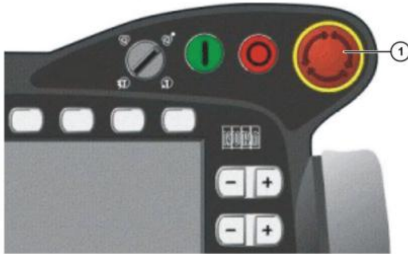
Figure II .8: 1) Interrupteur d'ARRÊT D'URGENCE au KCP.
