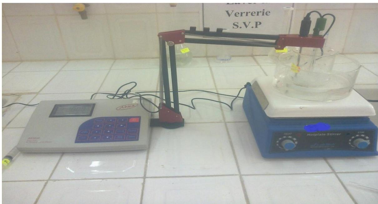
**Figure II-2.** Montage de l'extraction liquide-liquide.
