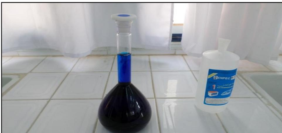
**Figure 3.7.** La solution mère de bleu de méthylène utilise avec le charbon actif.
