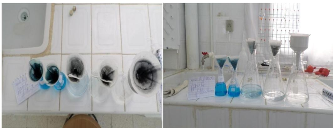
**Figure 3.13.** Procédé de filtration de CA par rapport au bleu de méthylène.
