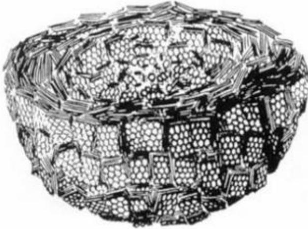
**Figure 1.1.** Vue en coupe d'une particule de noir de carbone.
