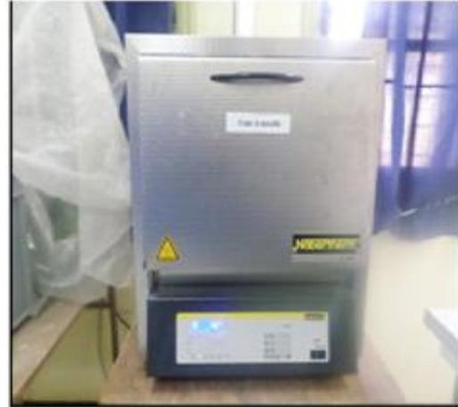
**Figure 3.3.b.** Four à moufle utilisé dans l'activation du noir de carbone.
