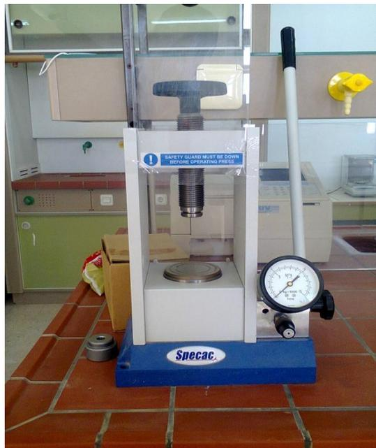
**Figure III.11:** Presse hydrostatique utilisée pour la préparation des pastilles
