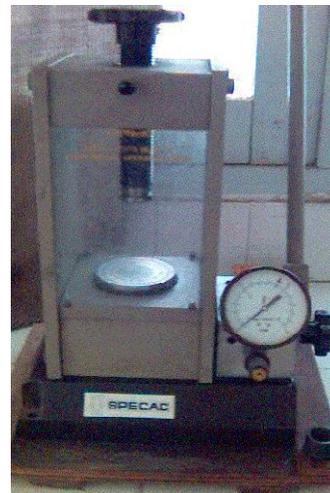
**Figure II.3:** Presse hydrostatique utilisée pour la préparation des pastilles[9]
