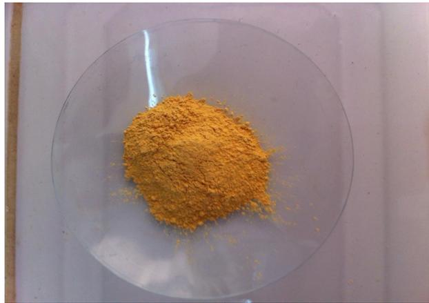
**Figure III.2:** Oxyde de plomb
