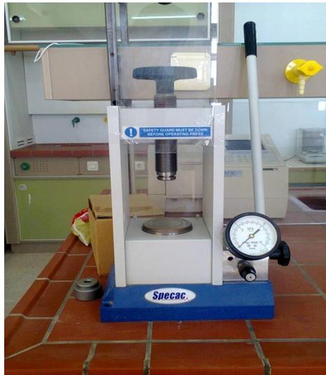
**Figure III.7:** Presse hydrostatique utilisée pour la préparation des pastilles.
