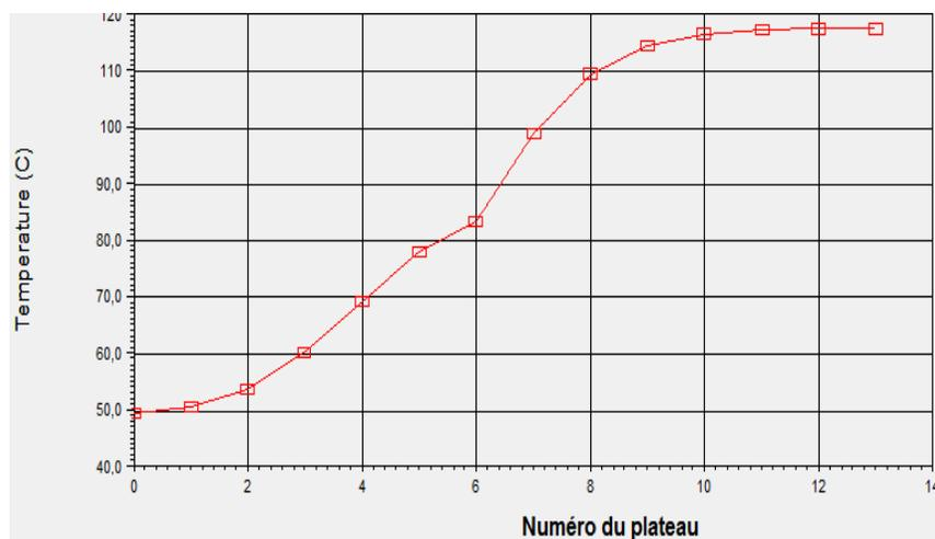
**Figure IV.25 :** Variation de température en fonction de numéro du plateau avec modèle NRTL dans la deuxième colonne
