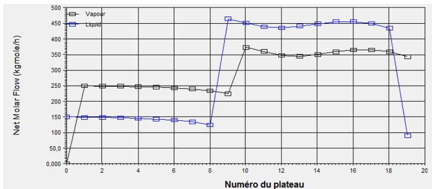
**Figure IV.14 :** Variation des débits molaires dans la première colonne de distillation
