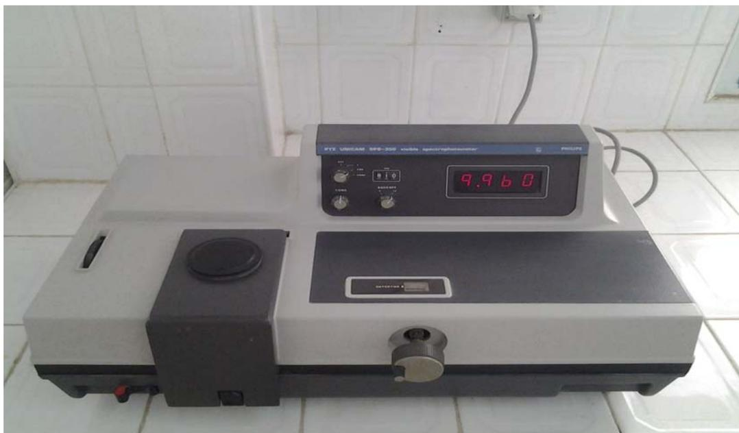
Figure 4 : spectrophotomètre PYE UNICAM SP6-350
