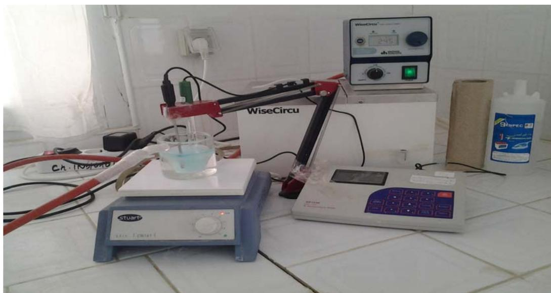
Figure 5 : Montage de l'extraction liquide-liquide .
