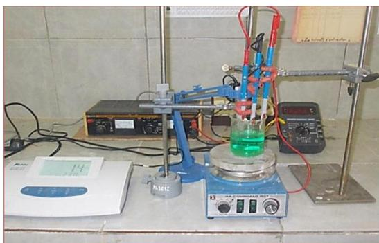
Fig. (III.4) : Schéma de montage d'électrodeposition.
