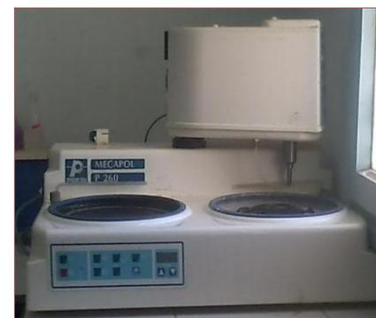
Fig. (III.1) : Schéma de polisseuse utilisé dans le polissage mécanique.
