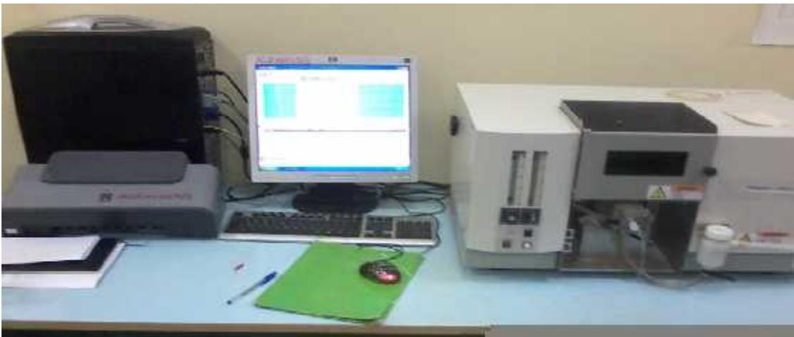
**Figure III.2:** Spectrophotomètre à absorption atomique
