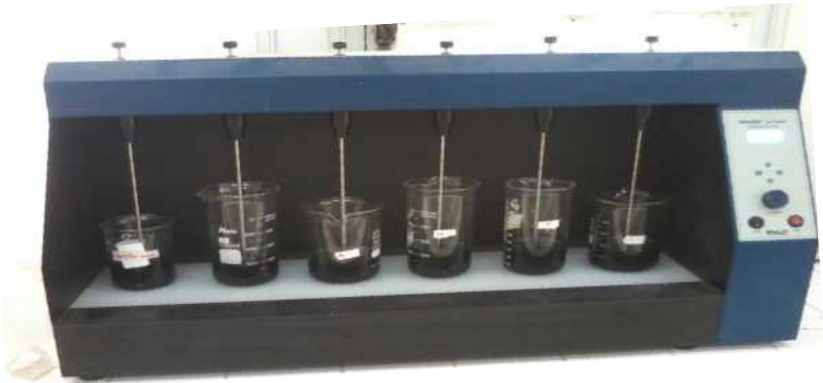
**Figure III.1.**Agitateurs (Jar teste).
