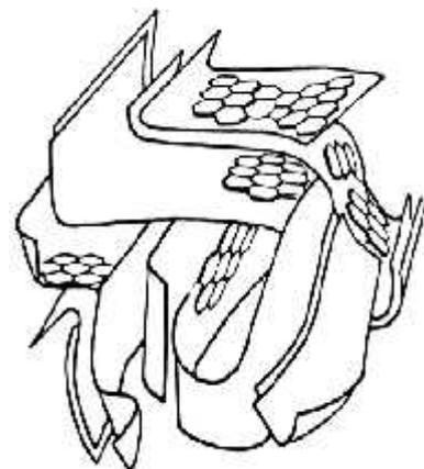
**Figures II.4 :** Structure du charbon actif vu sous un microscope électronique
